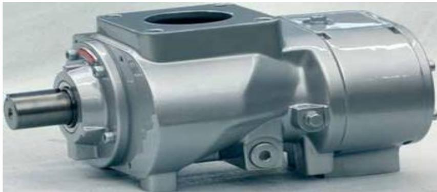
3.1.1、主机的主要构造是由转子、机壳（汽缸），轴承和轴封组成。确切的说就是两根转子（一对阴、阳转子）两端套着轴承装在机壳内，把空气从一端吸入，依靠阴阳转子的相对转动，齿顶对齿沟的齿合，进而把空气进行压缩，提升气体的压力，然后从另一端排出。
