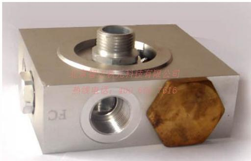
2.6.1、主要通过控制喷入主机的润滑油的温度来达到控制主机排气端的排气温度。机头排气温度过低，水分会在油分罐析出，造成润滑油乳化。油温 $\leq 70^{\circ}\text{C}$ 时温控阀控制住润滑油不让润滑油进入冷却器，当油温 $> 70^{\circ}\text{C}$ 时温控阀只让部分热油经过油冷却器被冷却，冷却后的机油与另一部分未被冷却的热油混合进入主机，当油温 $\geq 76^{\circ}\text{C}$ 时，温控阀把通往油冷却器的通道全部打开，此时的热润滑油全部经过油冷却器冷却后再进入主机进行压缩。温控阀可理解为进入机头的油的温度调控阀。
